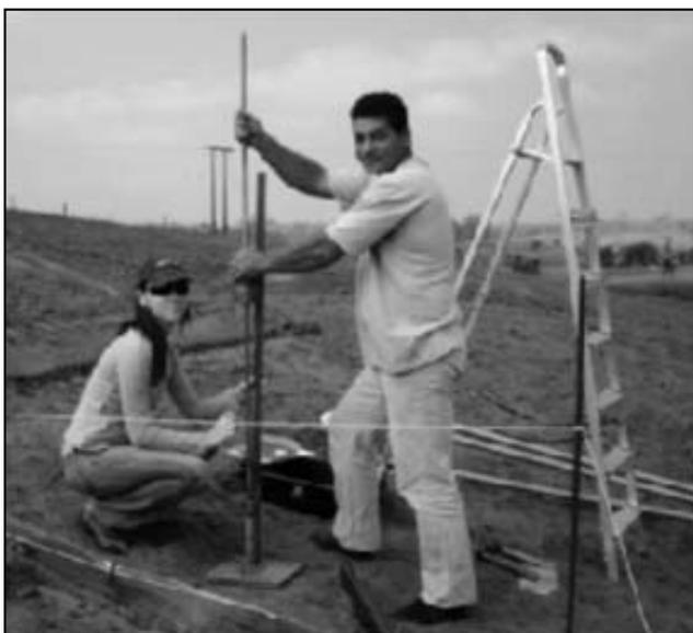
Figura 3. Visão geral do ensaio com penetrômetro dinâmico.
