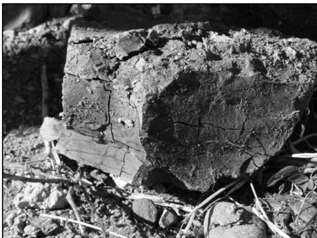
Figura 18. Fisuras y pérdida de humedad.
